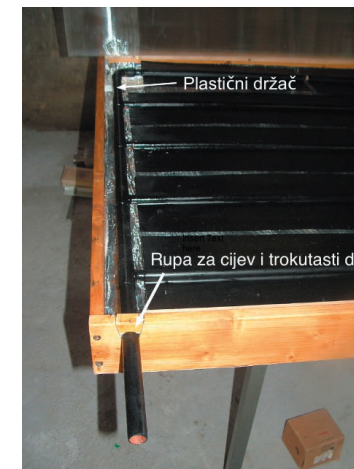
Slika 7. Rupa za ulaznu i izlaznu cijev i umetanje apsorbera
